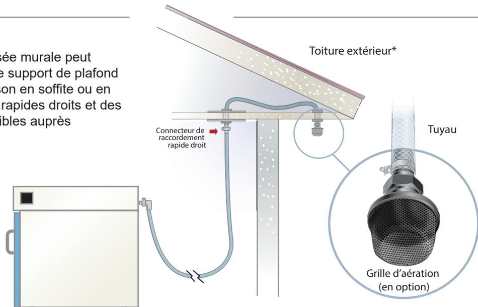
**\* Remarques :** Les directives de l'AAMI recommandent pour tous les stérilisateurs à OE de prévoir un tuyau d'échappement dédié à l'appareil, avec une évacuation directe vers l'extérieur ou par l'intermédiaire d'un dispositif antipollution. Le conduit d'évacuation doit déboucher à plus de 7,6 m de toute prise d'air frais du bâtiment ou de toute voie de circulation de piétons ou d'animaux, et doit empêcher l'oxyde d'éthylène d'être libéré dans le bâtiment ou d'y être aspiré.
