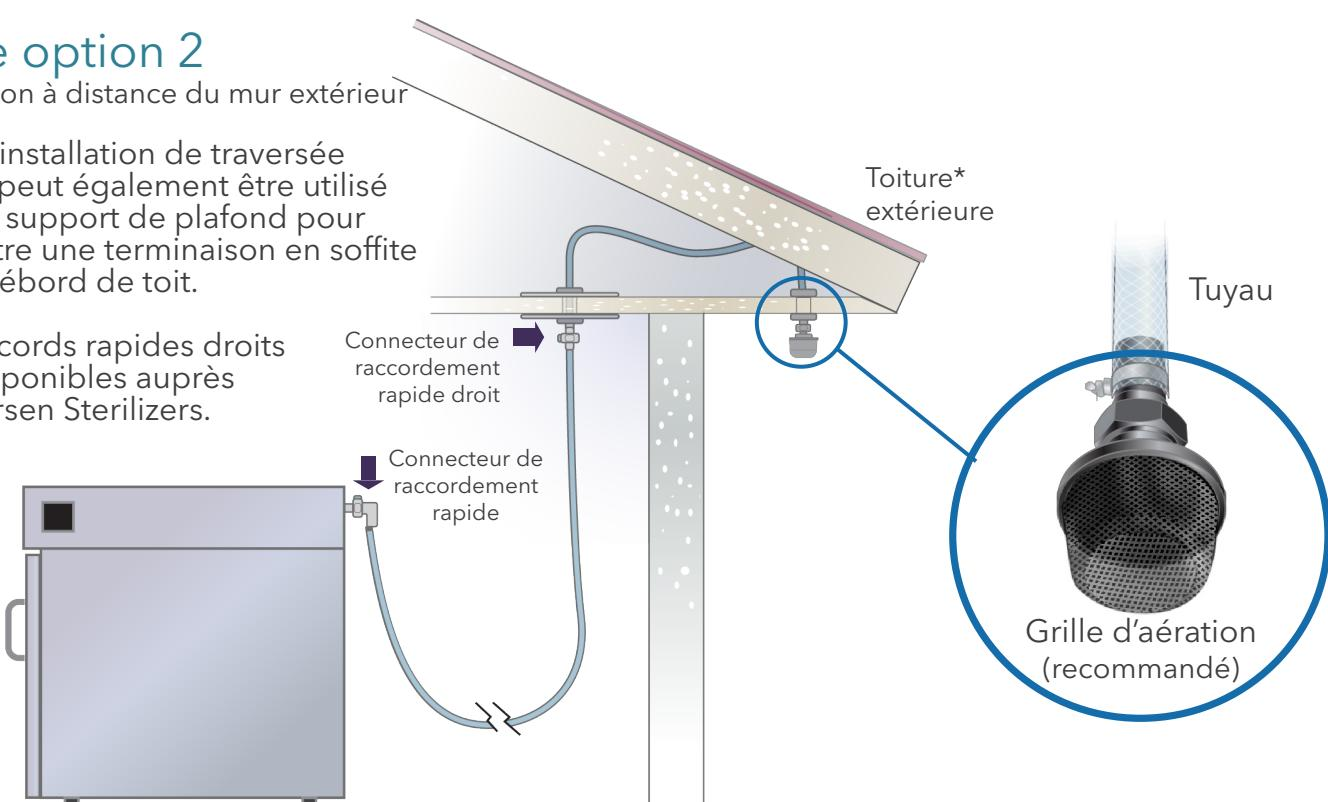
**Important :** Chaque stérilisateur EO Gas 4<sup>PLUS</sup> doit disposer de sa propre évacuation vers l'air extérieur. Il n'est pas possible de réunir les flux de gaz d'échappement de plusieurs stérilisateurs en un seul circuit d'évacuation vers l'extérieur.
