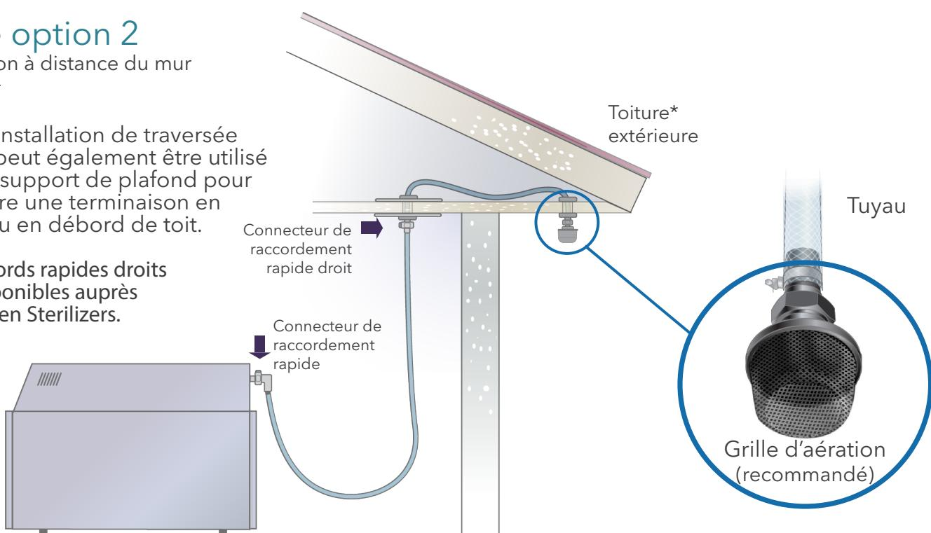
**Important :** Ne pas réunir l'échappement de plusieurs appareils en un flux de gaz d'échappement unique, cette situation peut altérer la sécurité et les performances du stérilisateur.
