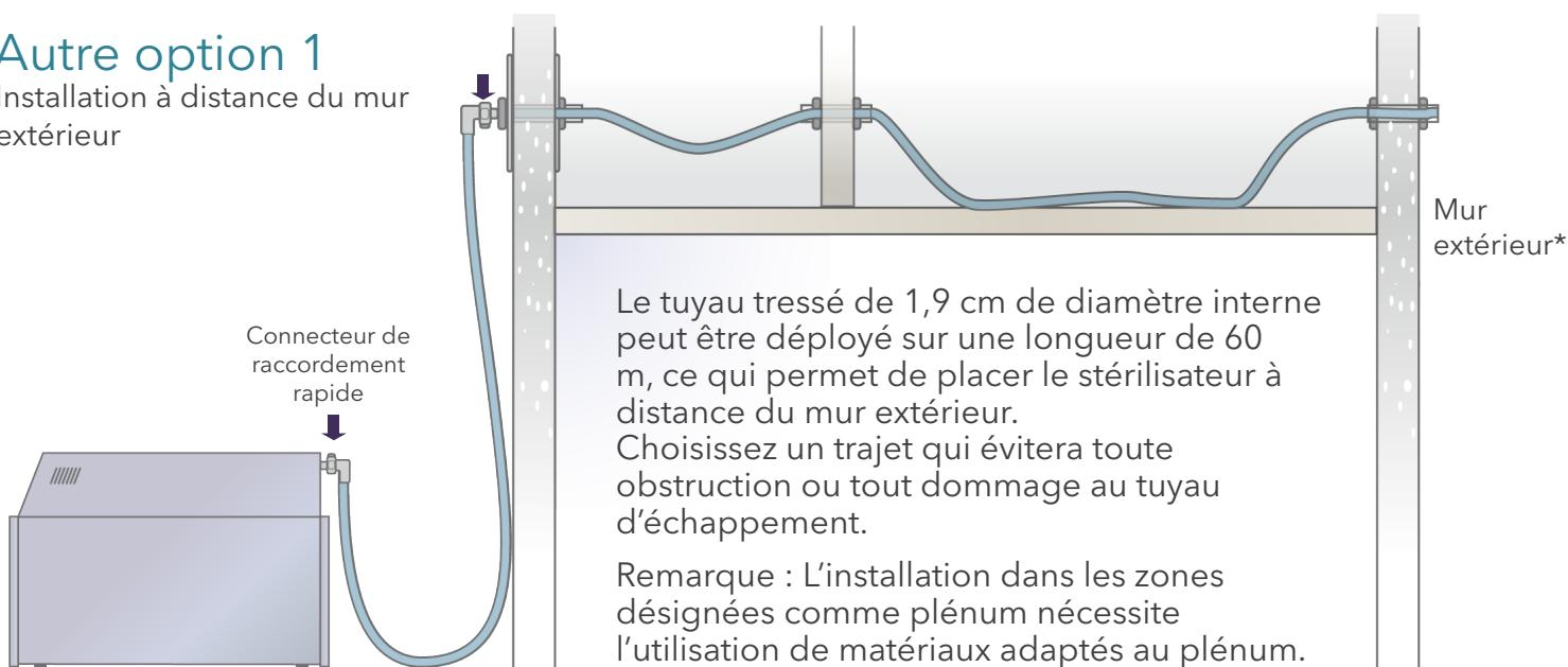
Le tuyau tressé de 1,9 cm de diamètre interne peut être déployé sur une longueur de 60 m, ce qui permet de placer le stérilisateur à distance du mur extérieur. Choisissez un trajet qui évitera toute obstruction ou tout dommage au tuyau d'échappement.
